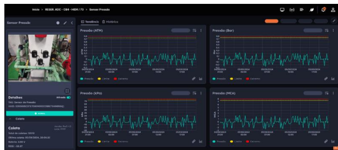
Dados transmitidos para plataforma Retina através do Gateway Bolt 1.0
