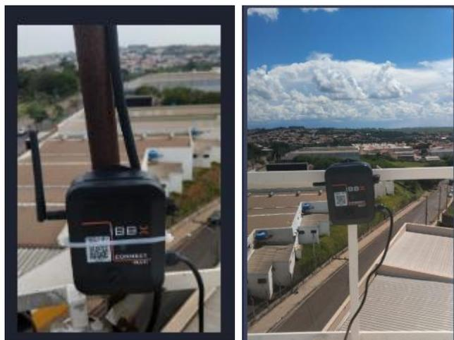
Correção: O Connect foi instalado em outro local, longe da fonte de interferência
