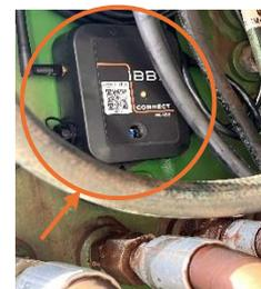
Figura: Instalação do Connect 2.0 no acoplamento interno da colhedora
