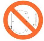
Não instale o dispositivo em superfícies que atinjam uma temperatura superior a 95°C.
