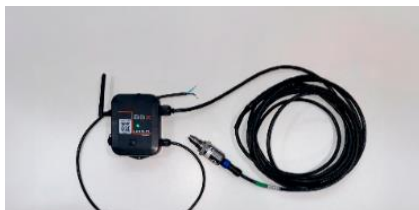
Figura: Connect 2.0 + Sensor para medir a qualidade do óleo
