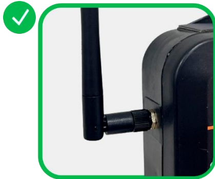
Figura: Antena Rosqueada até o final
