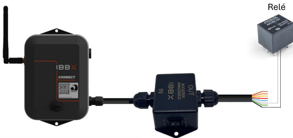
Figura: Exemplo de Configuração física da Porta Atuadora com Booster e relé
