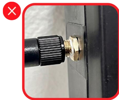
Figura: Antena com sobra de rosca
