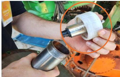
Figura: Instalação do transdutor de qualidade de óleo
