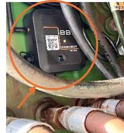
Figura: Instalação do Connect 2.0 no acoplamento interno da colhedora
