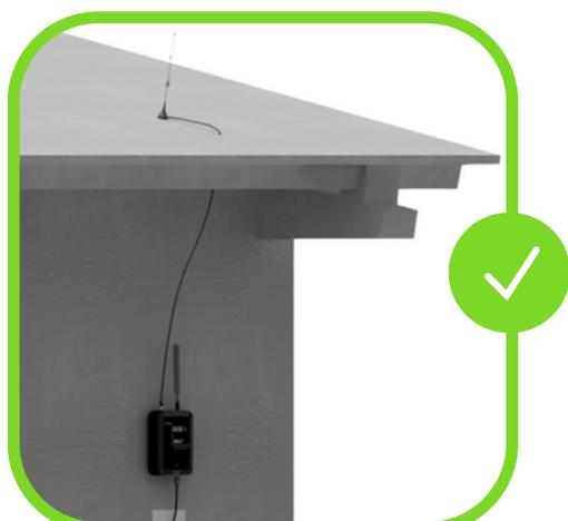
Não instalar o IBBX BOLT em contato direto em uma superfície
