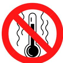
**Não instale o dispositivo em superfícies que atinjam uma temperatura superior a 95°C.**
